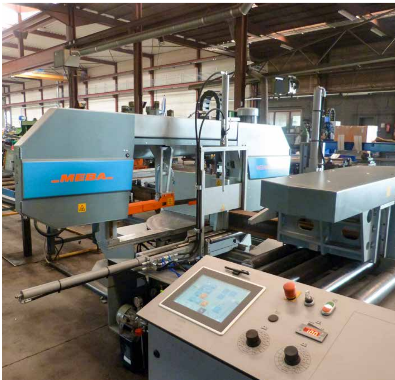
De Tollenaere leverde en plaatste een volautomatische bandzaagmachine type 410 DGA-2300 van MEBA.
