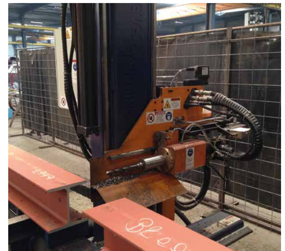
Dit systeem boort horizontaal in plaats van verticaal, waardoor het ideaal is voor het boren van bredere profielen.
