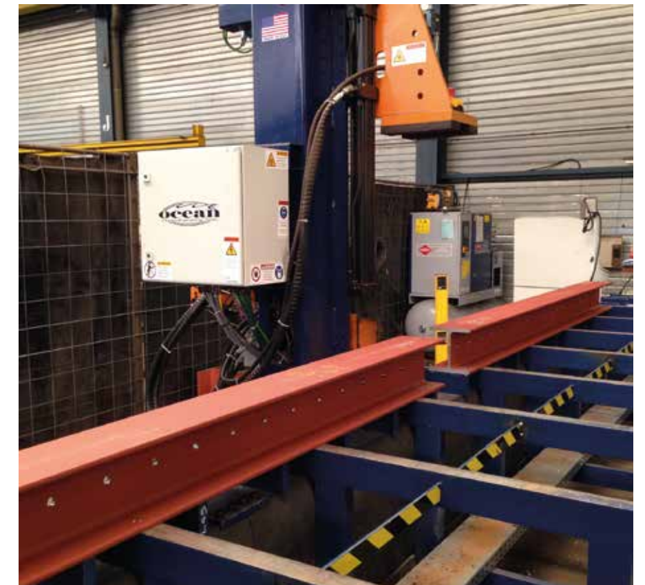
De demonstratie van de Ocean Avenger MDL-1000 boorstraat gebeurde in Berlijn, aangezien er in België nog geen installaties bestonden.
