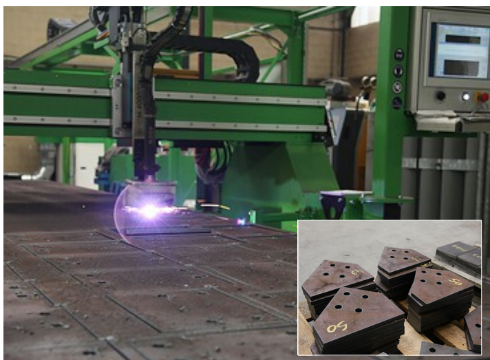
De plasmasnijmachine wordt gebruikt om onder meer kop- en voetstukken van 15 mm dikte uit staalplaten te snijden. De contour cut techniek maakt het mogelijk om heel fijne insnijdingen in die stukken te maken
