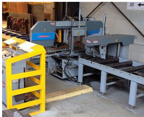
Links: De nieuwe 335DGA-2300 zaagmachine van Meba. Rechts: de boorstraat voor de bewerking van profielen
