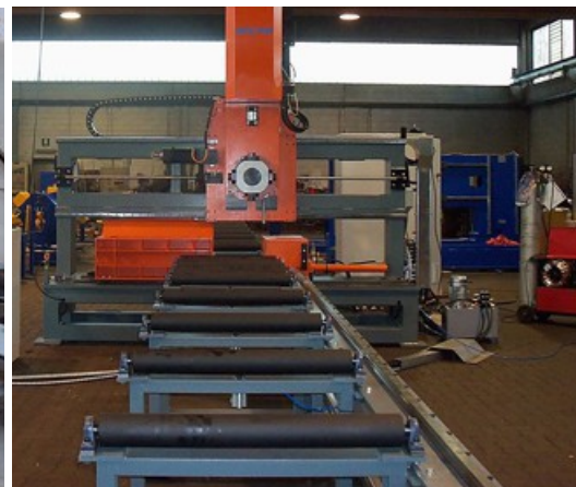
Links: De nieuwe 335DGA-2300 zaagmachine van Meba. Rechts: de boorstraat voor de bewerking van profielen
