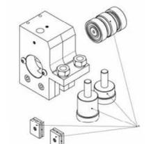
Robusto corpo guida lama così strutturato: cuscinetti verticali sfalsati per un primo raddrizzamento, 4 placchette widia (19x25 mm) di contenimento regolabili e un anello temprato posto sul dorso della lama a contrasto dello sforzo di taglio (questo aumenta considerevolmente la durata della lama rispetto ad un contrasto strisciante). Queste caratteristiche permettono una elevata precisione verticale nel taglio
